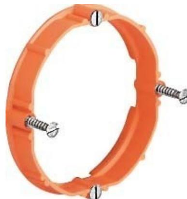
Kaiser Putzausgleichring 10mm 9155-61 Ausgleichshöhe 10mm, Durchmesser 68mm, Form rund, Anwendung Einbaudose, Montageart Hohlwand, Aufbau-Abzweigring, Zum Ausgleich zu tief sitzender Dosen, für Gerätedosen und Geräte-Verbindungs-dosen mit 60 mm Durchmesser, Schraubabstand 60 mm.
