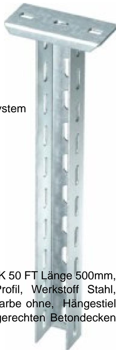
OBO Bettermann Vertr U-Stiel m.Kopfplatte 500mm US 5 K 50 FT Länge 500mm, Profilbreite 50mm, Profilhöhe 50mm, Ausführung U-Profil, Werkstoff Stahl, Werkstoffgüte sonstige, Oberfläche tauchfeuerverzinkt, Farbe ohne, Hängestiel mit angeschweißter Kopfplatte, zur Befestigung an waagerechten Betondecken und Stahlträgern
