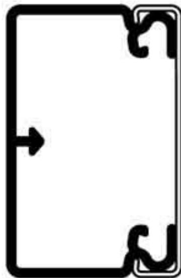
Kleinhuis Kanal gr 40x60 RAL7030 HKL4060.1 Höhe 40mm, Breite 62mm, Länge 2000mm, Werkstoff Kunststoff, Werkstoffgüte PVC, Oberfläche unbehandelt, Farbe steingrau, RAL-Nummer 7030, Anzahl der festen Trennwände 0, Anzahl der steckbaren Trennwände 1, Befestigungsart Bodenlochung, Ausführung Deckel lose, Mit Kabelhalteklammer, Kanalober- und Unterteil aus bleifrei stabilisiertem PVC
