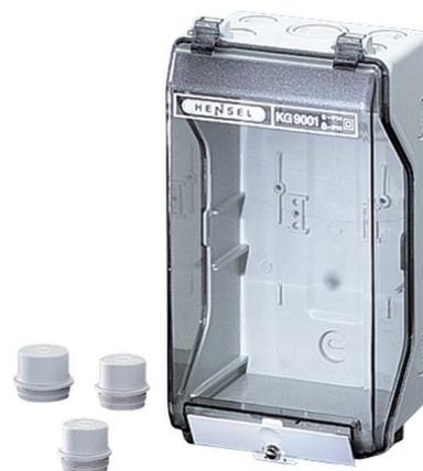
Hensel Leergehäuse 136x253x115mm KG 9001 Höhe 253mm, Breite 136mm, Tiefe 115mm, Einbautiefe 95mm, RAL-Nummer 7035, Anbaumöglichkeit, Werkstoff des Gehäuses Kunststoff, Oberfläche ohne, Schutzart (IP) IP65, Art des Deckels transparent, Leergehäuse zum Einbau von Geräten.
