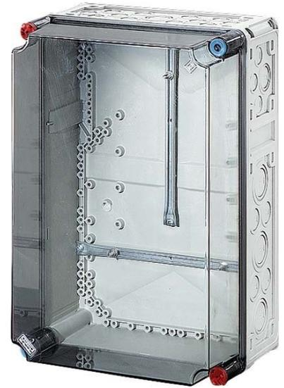
Hensel Zählergehäuse 300x450x214mm T=190 Mi 2310 Montageart Aufbau, Werkstoff Kunststoff, Einbautiefe 190mm, Schutzart (IP) IP65, Höhe 450mm, Breite 300mm, Tiefe 214mm, Isolierstoffgekapselte Niederspannungs-Schaltanlage in Kastenbauform als "Typgeprüfte Schaltgeräte-Kombination" TSK nach IEC 60 439 -1 für Wandaufbau.
