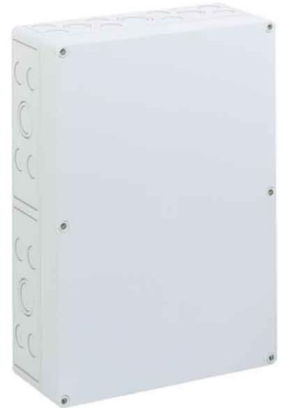
Spelsberg Leergehäuse TK PS 3625-11-m Höhe 361mm, Breite 254mm, Tiefe 111mm, Einbautiefe 97mm, RAL-Nummer 7035, Werkstoff des Gehäuses Kunststoff, Schutzart (IP) IP66, Leitungseinführung, Art des Deckels geschlossen, Leergehäuse, Bemessungsisolationsspannung 690 V, aus Polystyrol.
