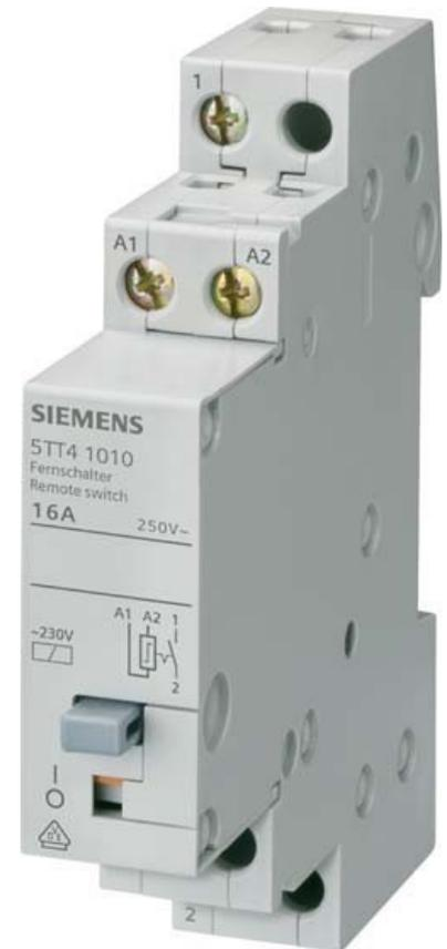
Siemens Indus.Sector Fernschalter 230VAC 16A 1S 5TT4101-0 Funktion mechanisch Schalter, Montageart DIN-Schiene, Breite in Teilungseinheiten 1, Einbautiefe 70mm, Anzahl der Schließer 1, Anzahl der Öffner 0, Anzahl der Wechsler 0, Steuerspannung 1 184 ...
