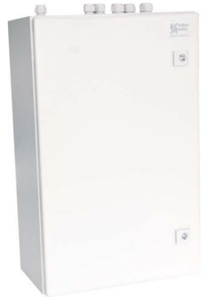
WindowMaster RWA-Zentrale 20A 5 +/-24 WSC 520 0IIS E1 Mit Netzteil, Höhe 600mm, Breite 380mm, Tiefe 210mm, Betriebsspannung 24V, Modulare RWA-Zentrale, 20 A, 2 x Input-/Output-Modul WSA 5IO, 1 x Motorenmodul 5SM, Akkus sind separat zu bestellen.
