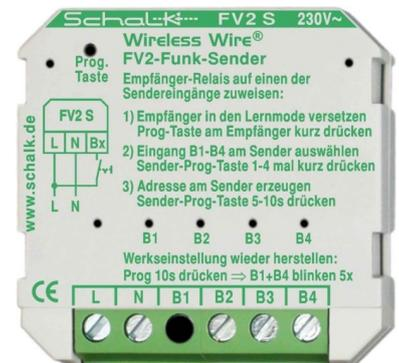
Schalk Funk-Sender UP 4 Eingänge FV2 S 230V AC Funkfrequenz 433,92MHz, Reichweite 50m, Anzahl der Befehle 4, Funktaster unter Putz, Stromversorgung 230 V AC,
